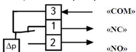
Если перепад давления ниже установленного значения контакт находится в исходном состоянии «1». При превышении перепада давления происходит переключение контакта из положение «1» в положение «2».
