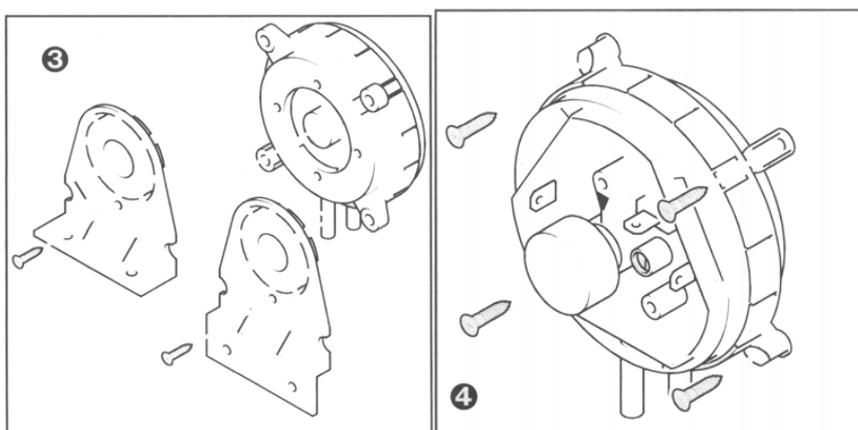
Для предотвращения попадания влаги реле устанавливается выше точек отбора давления, т.е. реле необходимо установить вертикально так, чтобы патрубки для подключения трубок подвода давления располагались снизу. При отсутствии накопления конденсата возможна установка реле в горизонтальном положении.
